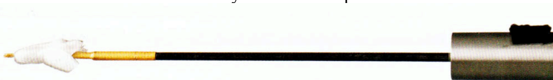
Пример вывода шомпола слишком далеко из дульного среза. Патч или ершик должны только показаться из дульного среза.
