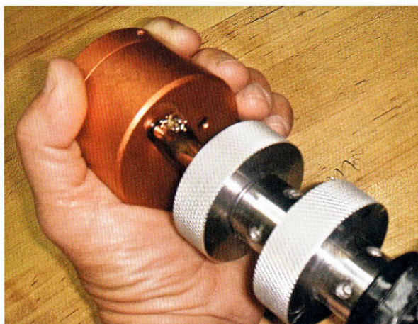
Обточка шейки с помощью электродрели и устройства Don Nielson Turner.
