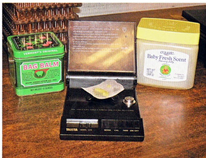
Комбинация Bag Balm и Вазелина, используемая в качестве смазки для оболочек и посаженных сердечников.
