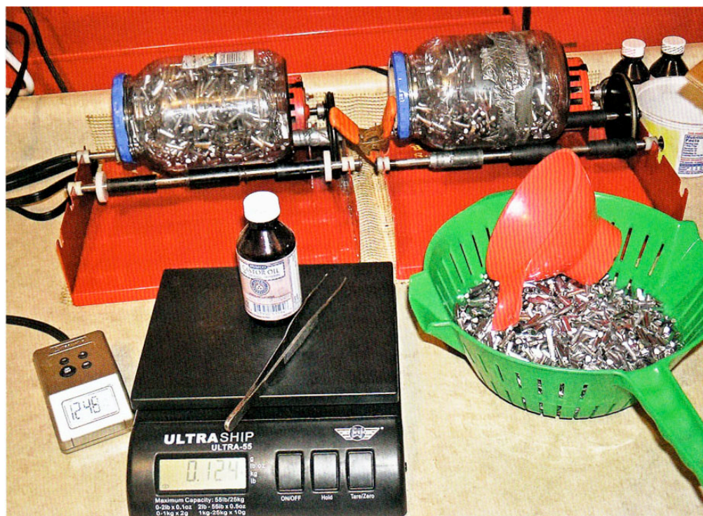
Фотография галтовочного устройства, в котором проходят смазку 4000 сердечников.
