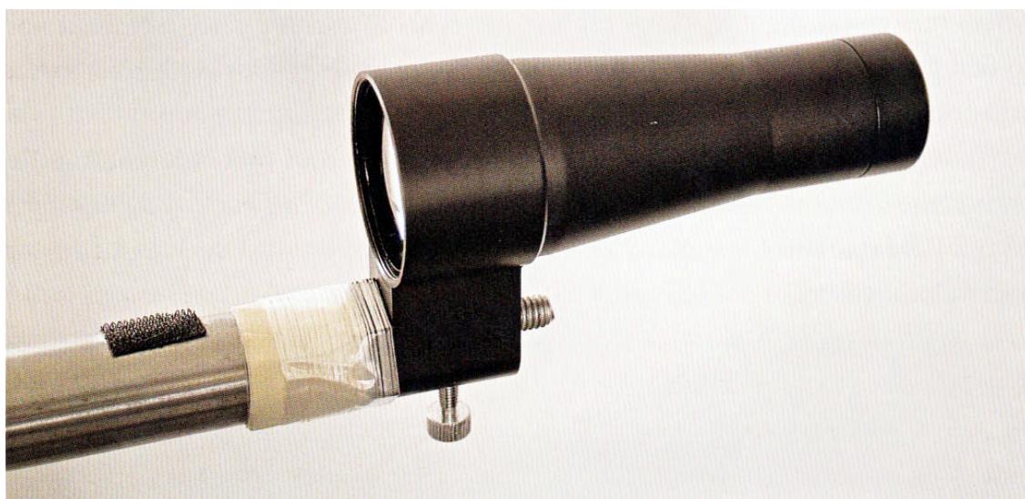
Коллиматор холодной пристрелки примотан лентой к концу ствола.
