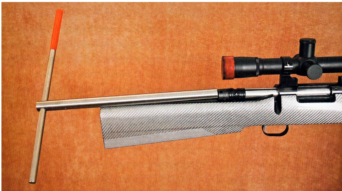
Ключ доступа сзади извлекает ствол.
