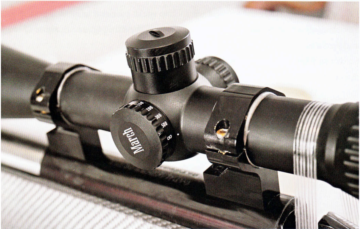
Оба кольца крепления прицела на месте перед подчисткой излишков J-B Weld.
