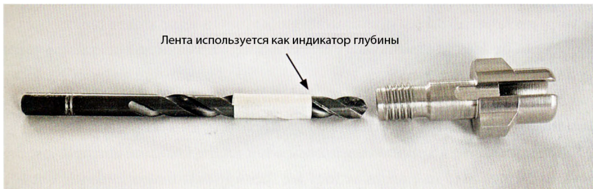
Сверло, подготовленное к удалению части направляющего ударник канала.
