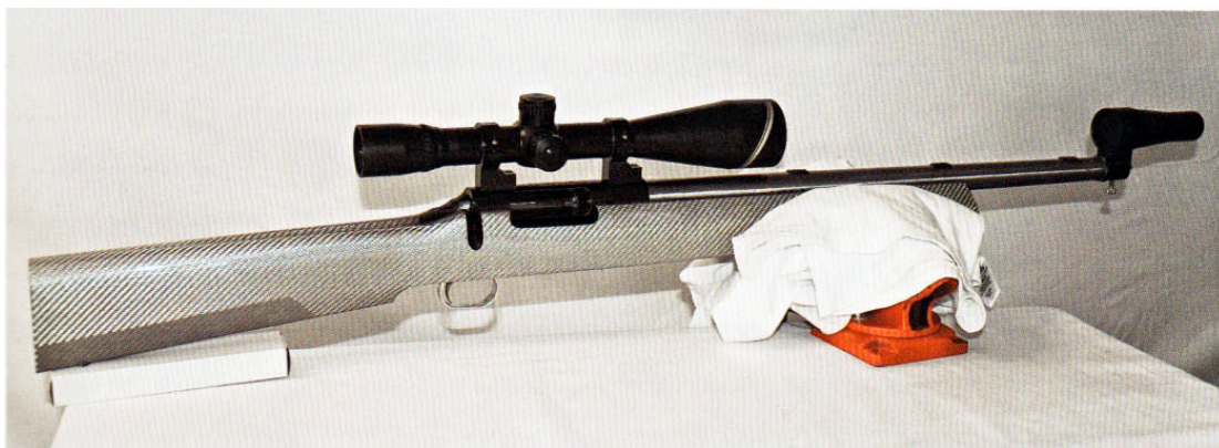
Винтовка закреплена в тисках, коллиматор холодной пристрелки примотан к стволу.
