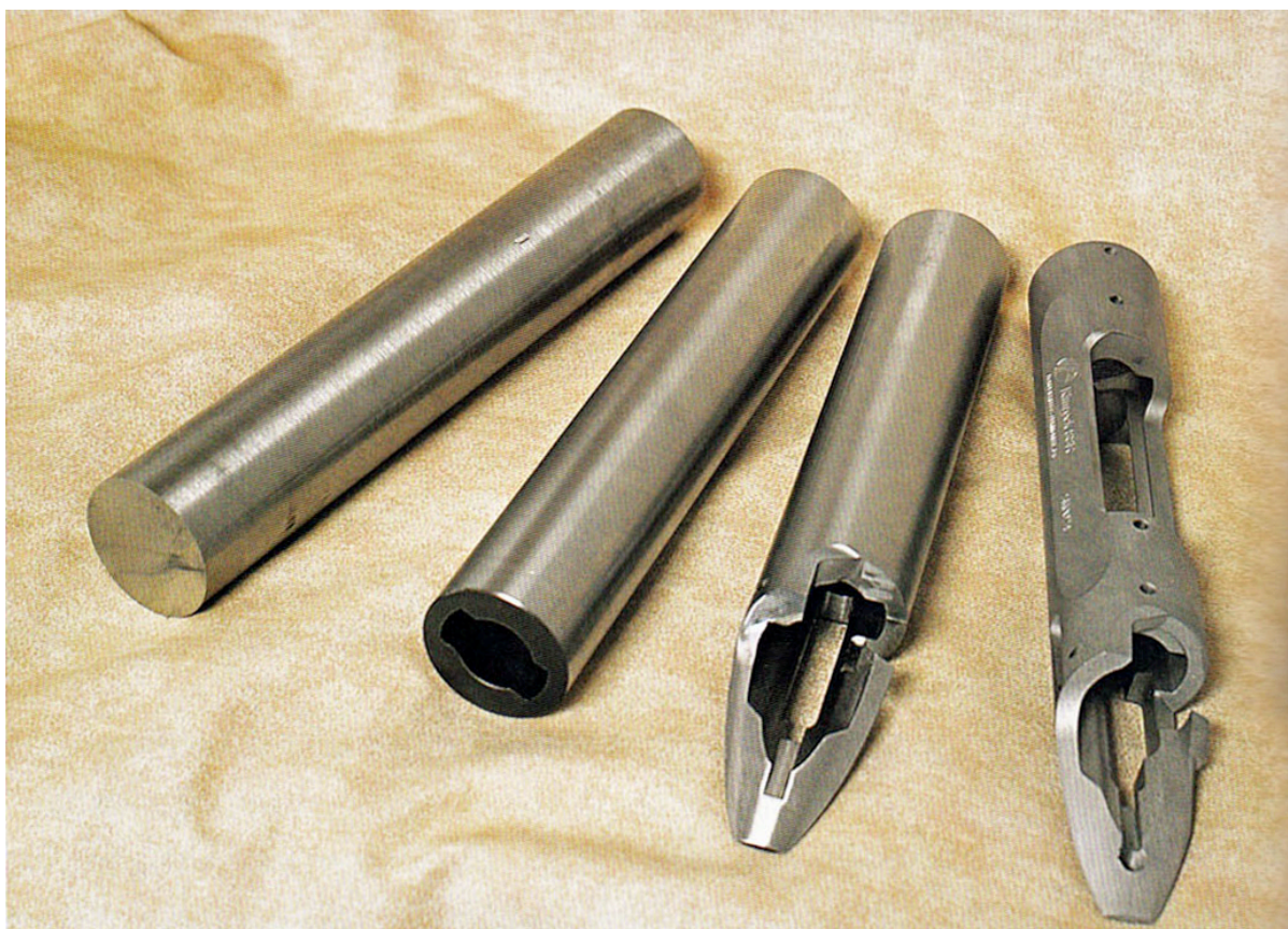
Этапы создания ствольной коробки Rimrock.
