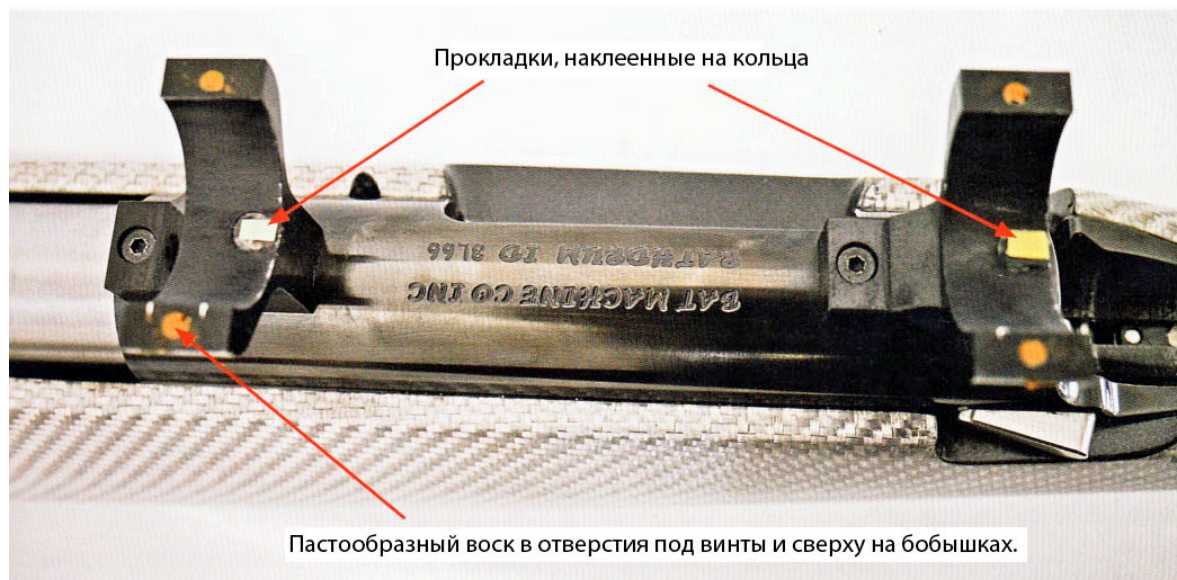
Прокладки, приклеенные к нижним половинкам колец.
