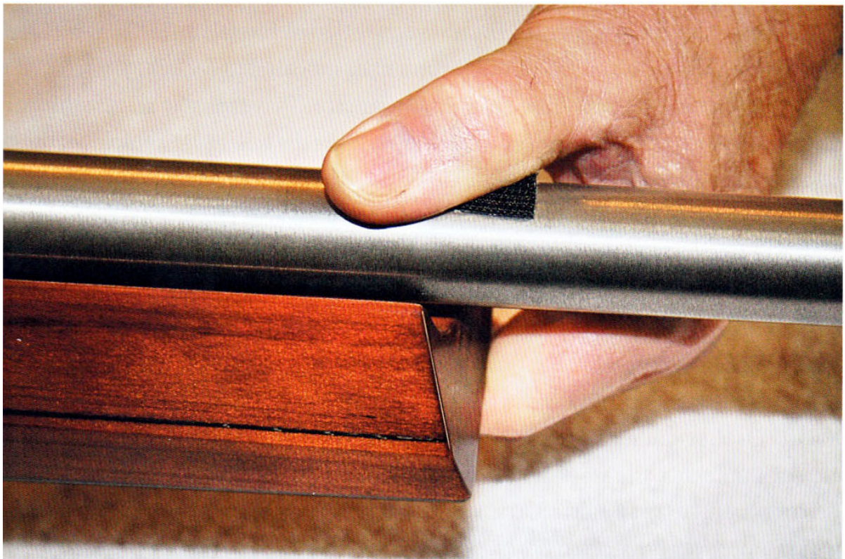
Проверка вертикального изгиба цевья ложи.
