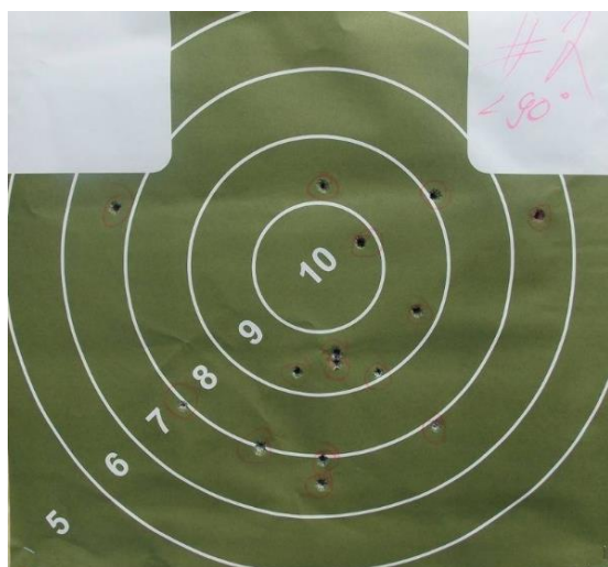
Рисунок 1. Картина пробойн на мишени. Реальная мишень и смоделированная по ней картина точек попадания
