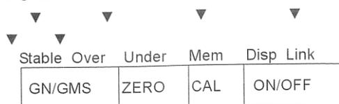
**Stable:** когда черная стрелка указывает на значение Stable -«стабильный», вес стабилен. Остальные индикаторы нужны для использования Диспенсера ChargeMaster.
