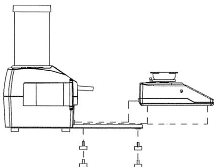
Шаг 1. Для подсоединения весов к диспенсеру, снимите 4 шурупа на нижней поверхности весов и заведите весы вдоль направляющих, пока элементы не соединятся. Поместите шурупы на место и затяните руками. **ИЗБЕГАЙТЕ СЛИШКОМ СИЛЬНОЙ ЗАТЯЖКИ.**
